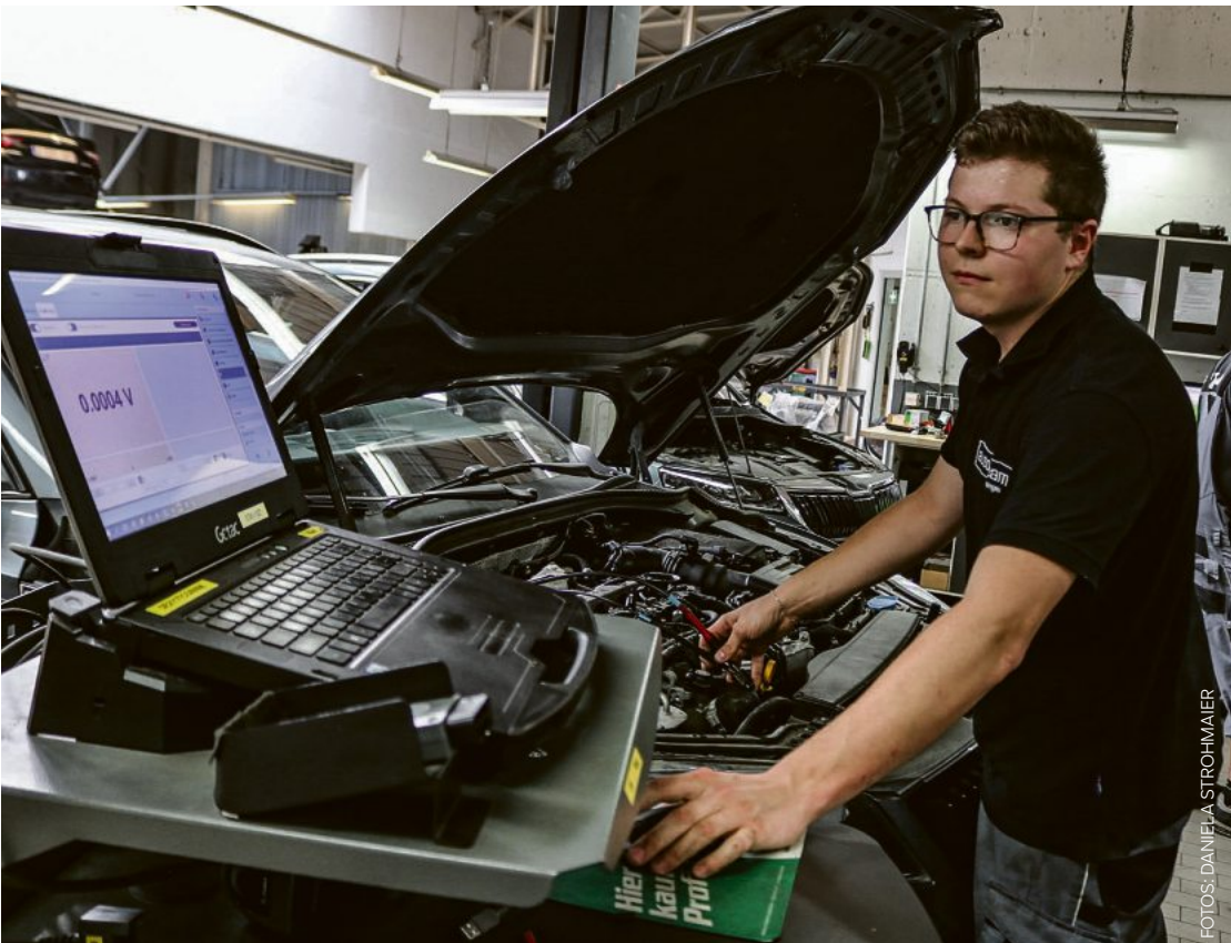
Am Computer prüft Nicke Wienecke die Spannungsversorgung des Ladeluftsensors.
